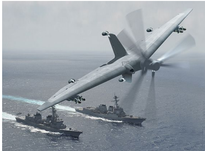
Figura 10 – Protótipo TERN - phase 3, utilizado para lançamento a partir de embarcações com dimensões reduzidas.
